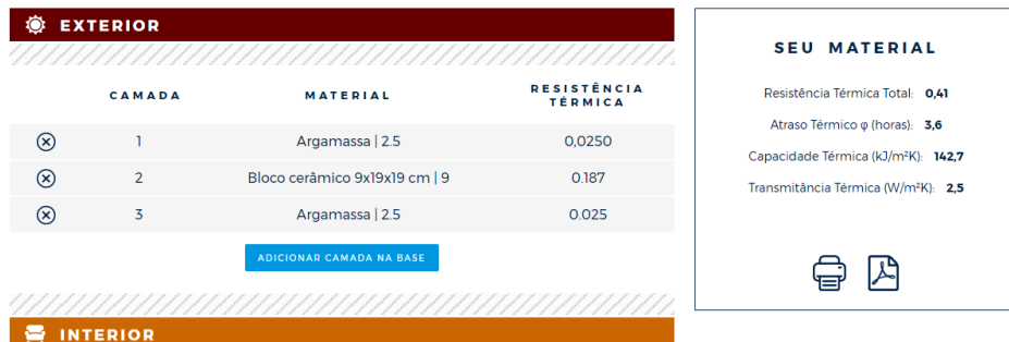
Figura 14 – Desempenho térmico da alvenaria de vedação de Goiânia
